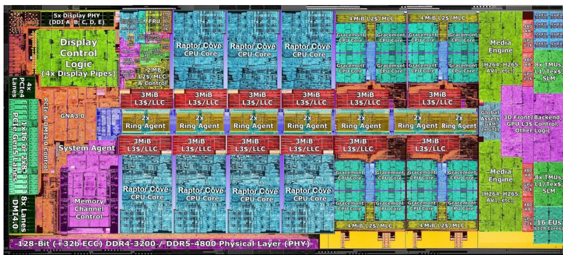
Процессор (CPU) Intel Core i7-13700 (с сайта Информационные технологии для экспертов, https://www.pc4xp.ru )
